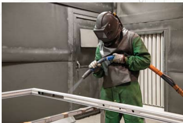
▲ Cabine de grenailage de 7mx3mx2m Grenaille inox martensitique - Pression de 1,2 à 7 bars
